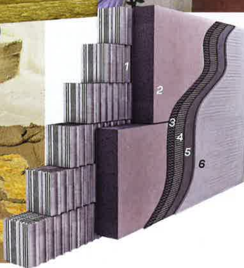
Skladba zateplovacieho systému: 1 – obvodové murivo 2 – Austrotherm GrEPS 80 F Reflex 3 – lepiaca malta 4 – výstužná vrstva – lepiaca malta s integrovanou textilnou mriežkou zo sklenených vlákien 5 – penetračný náter 6 – finálna fasádna povrchová vrstva
